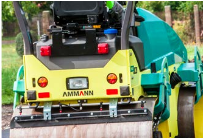
Yol aydınlatması ve geri vites alarmı
