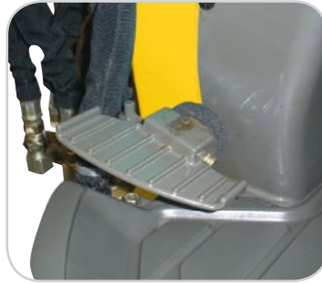
Geri çekilebilir pedallar (PTO, pedal ve dönüş kontrol pedalı)
