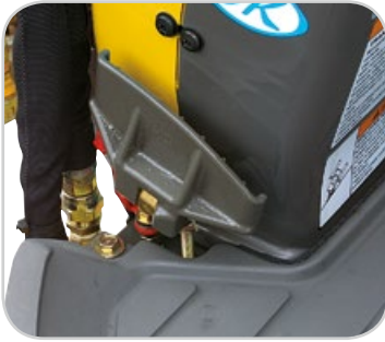
Geri çekilebilir pedallar (PTO, pedal ve dönüş kontrol pedalı)
